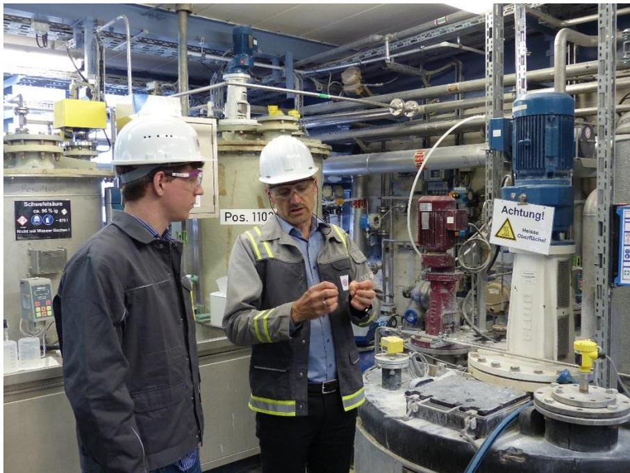
Bild 1 (Evonik): Dr. Thomas Pelster (r.) erklärt Johannes Hahmann (l.) am Fällbottich für gefällte Kieselsäure (Silica) den Produktionsprozess von Silica.
