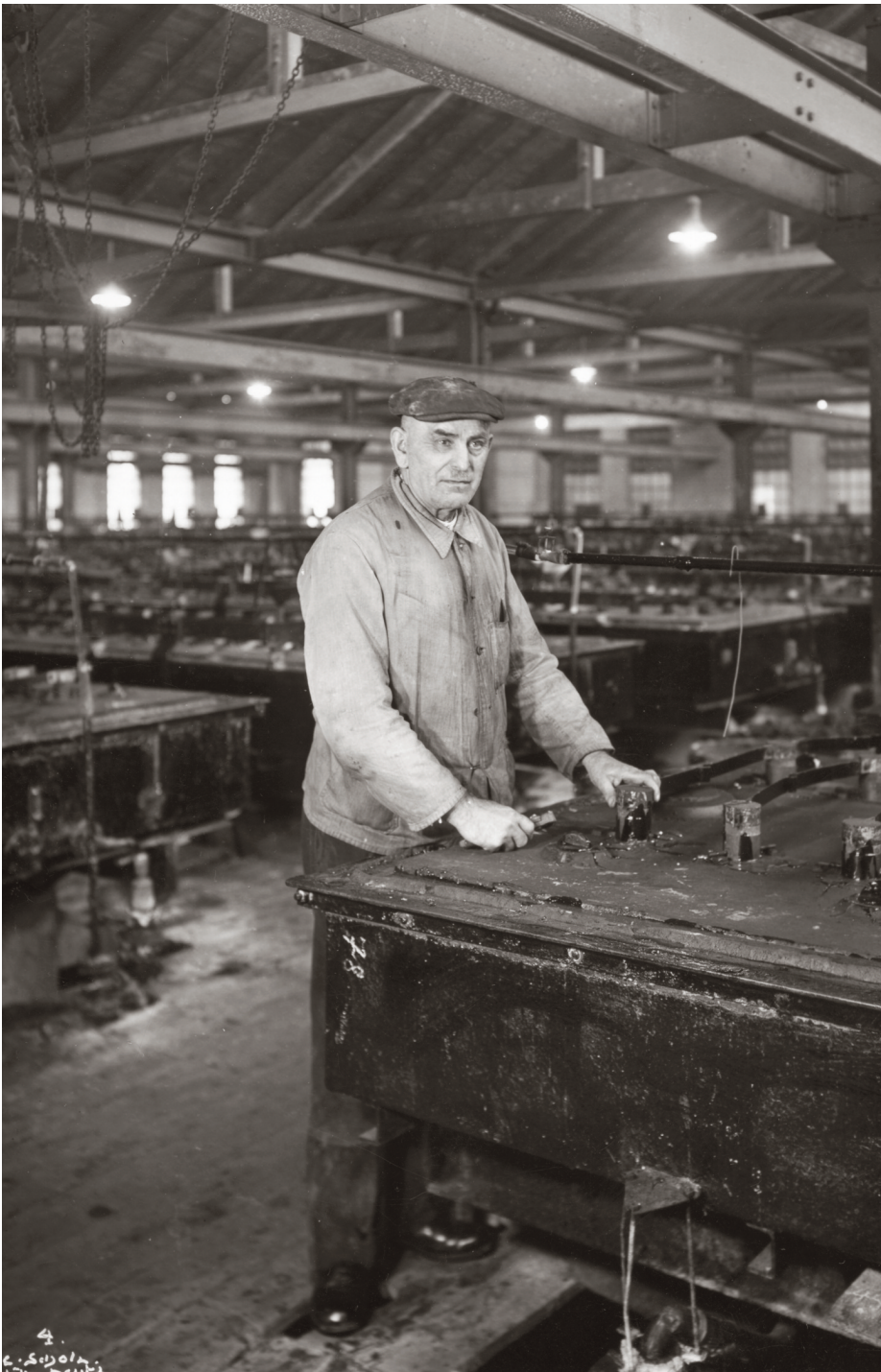
Mitarbeiter an einer Siemens-Billiter-Zelle um 1930
