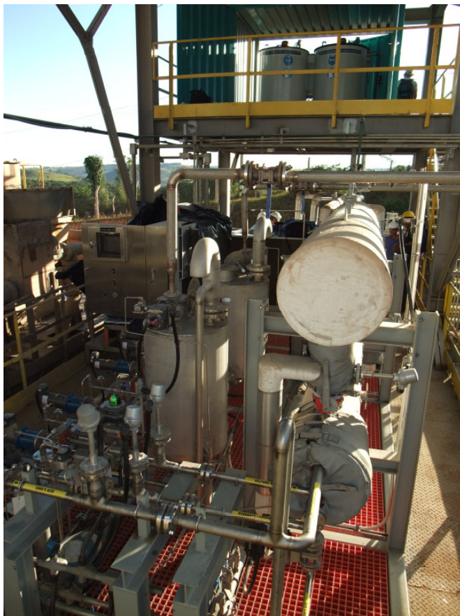
CyPlus®-System für Carosche Säure im Goldbergbaubetrieb Turmalina, Brasilien
