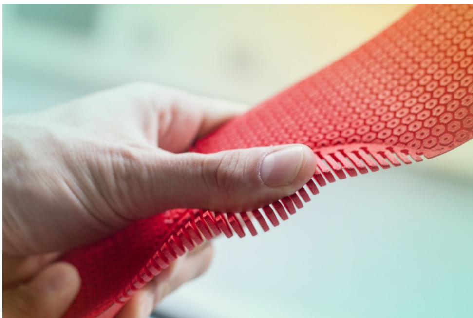
Bildunterschrift: Einlegesohlen aus dem 3D-Drucker. Die von Wiivv mittels 3D-Druck gefertigten Einlegesohlen sind auf die individuellen biomechanischen Eigenheiten eines Fußes abgestimmt und eignen sich für sportlich aktive Menschen sowie für Menschen, die berufsbedingt viel laufen und stehen.
