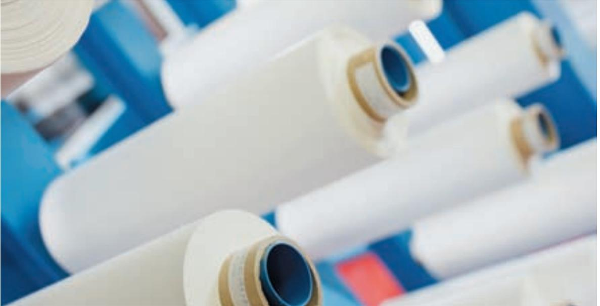
Innovation ist unser Antrieb: Evonik hat den keramischen Separator SEPARION® entwickelt – eine Folie, die es möglich macht, auch große Lithium-Ionen-Batterien zu bauen. Der Vorteil für Autohersteller: SEPARION® macht ihre Lithium-Ionen-Batterien sicherer, leistungsfähiger und sparsamer als herkömmliche Batterien.
