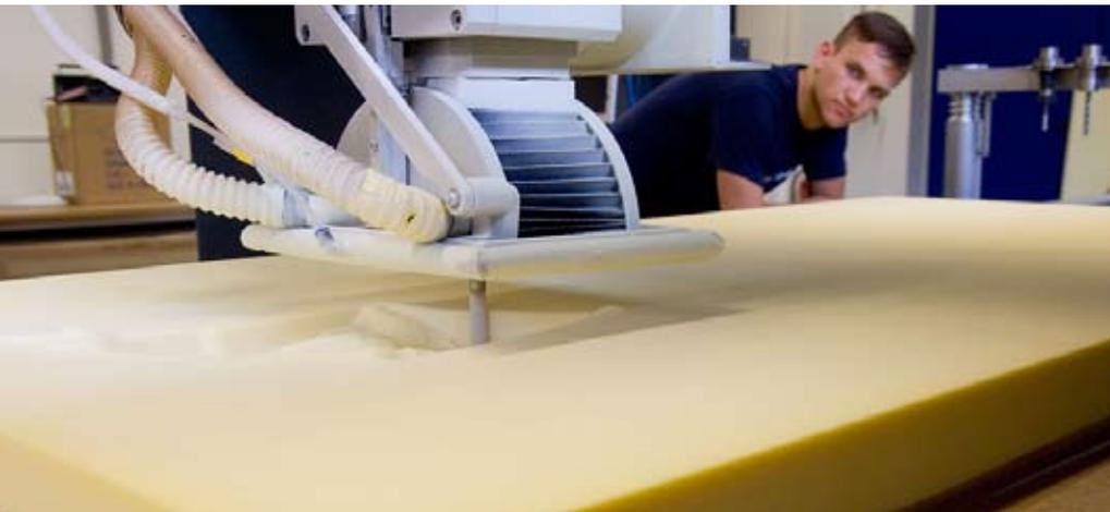
Von Darmstadt aus in alle Lüfte: ROHACELL® ist perfekt geeignet, den Kern eines Sandwichbauteils – beispielsweise in einem Hubschrauber-Rotorblatt – mittels hochpräziser CNC-Technik zu formen.
